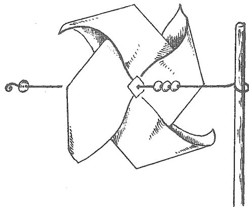
Jetzt klebst Du Dein Windrad in der Mitte mit ein wenig Klebstoff oder Klebeband zusammen, steckst eine Perle auf einen Draht – so wie Du es auch in der Zeichnung 5 siehst –, durchstichst Dein Windrädchen in der Mitte, fädelst noch ein paar Perlen auf und befestigst den Draht an einem Stöckchen.
